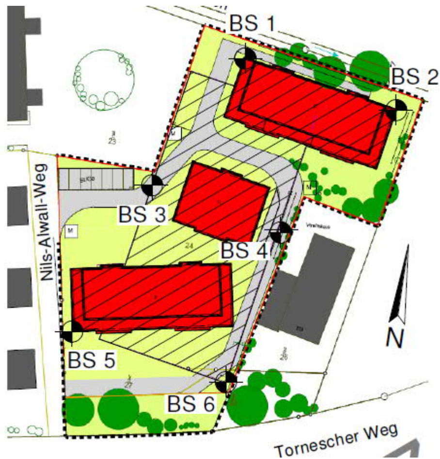
Abbildung 15 Lage der 6 Sondierbohrungen (Widell 2014 / 2017) im Plangebiet
